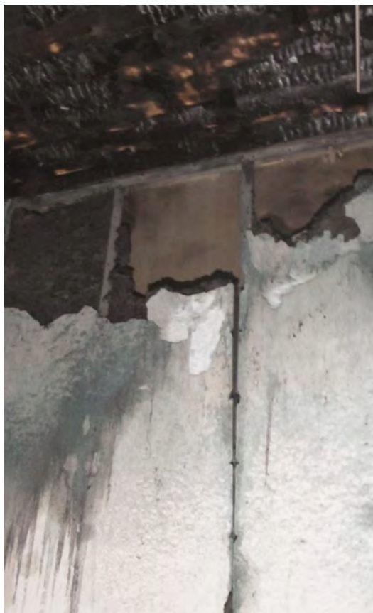
Abb. 4.15 Prüfkörper nach Brandversuch und Löschangriff
