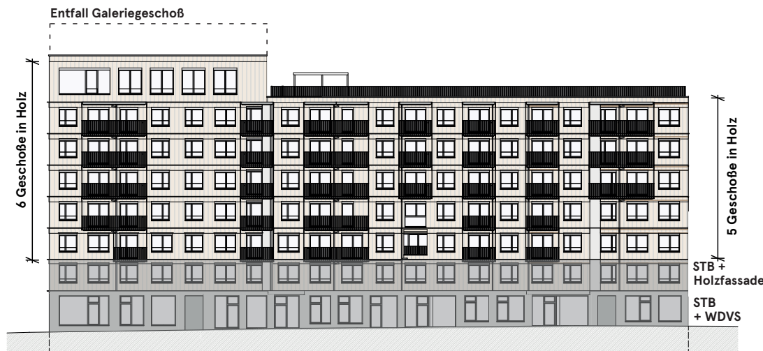
Abb. 4.9 Ansicht Nordfassade mit den geplanten Brandschutz- Anpassungen
