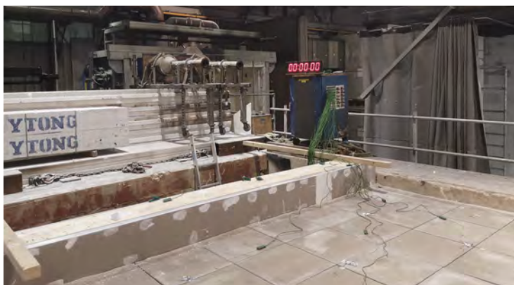
Abb. 4.11 (links) Decke und Außenwand im Brandversuch
